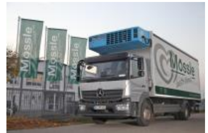
Seit einigen Monaten testet Mössle einen Mercedes Atego mit invertergesteuerter Kältemaschine von FRIGOBLOCK.
